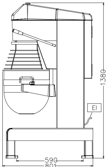
EI = Conexión eléctrica (energía)
